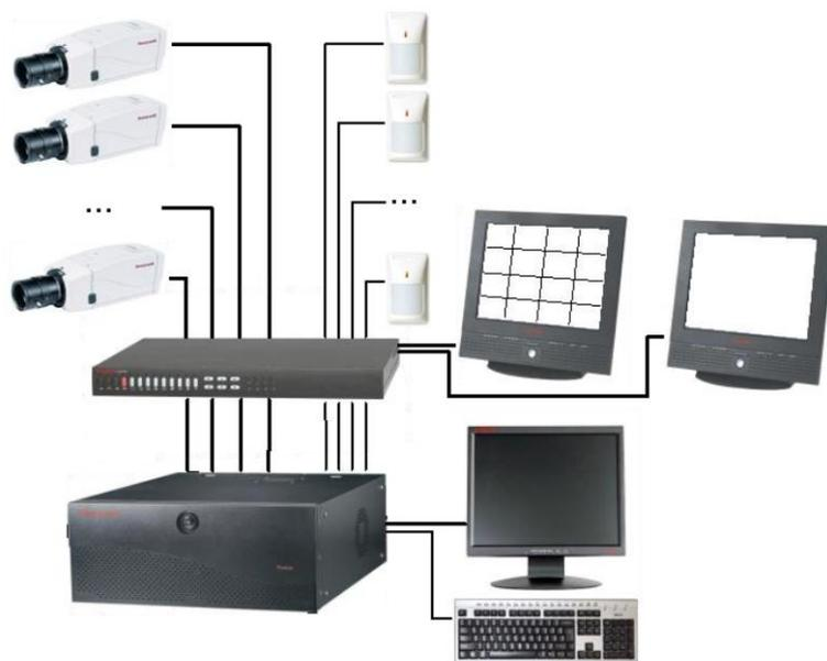
Рисунок 2.4 – Схема СВН с цифровым многоканальным видеорегистратором и расширенными возможностями
