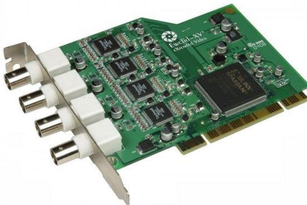
Рисунок 3.4 – Плата видео захвата te-9104e
